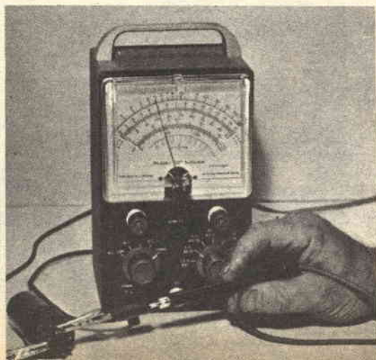
Fig. 5 - Per vedere se una valvola è bruciata, basta usare il voltmetro come misuratore di resistenze, con il commutatore inserito su « R x 10 » e collegare i puntali ai piedini della valvola a cui fa capo il filamento, identificati con l'aiuto di schemari e valvolari.
